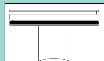
Tapón de terminación de nipple escarpado, disponible para reemplazar la muestra de ensayo en el agujero taladrado.
